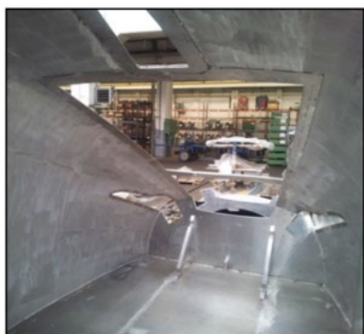
Slika 9.1: Absorpcijski komponenti iz aluminijaste pene (zgoraj) in vlaka ICE (spodaj) [63]
