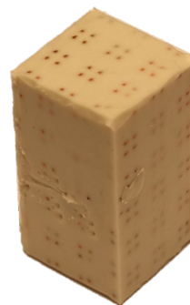
Slika 7.12: Kompozitna kiralna avksetična struktura
