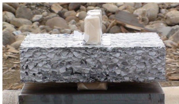
Slika 9.2: Sredica sendvič strukture za uporabo v zaščitnih ploščah za blaženje udarnega vala pri eksploziji [63]
