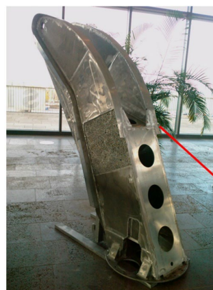
Slika 9.3: Nosilec tekstilnega stroja in dvigala, napolnjen z aluminijasto peno. [63]
