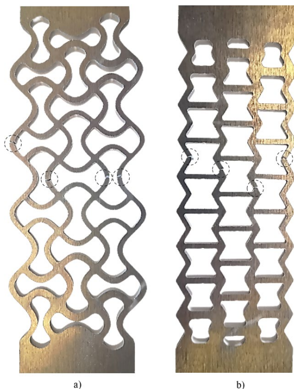
Slika 7.30: Mesta odpovedi celičnih povezav a) kiralna struktura, b) vbočena šestkotna struktura [72]
