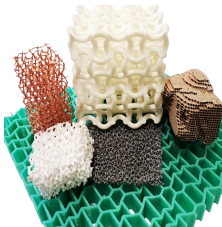
Slika 2.2: Moderni celični metamateriali, izdelani z različnimi proizvodnimi procesi [4].
