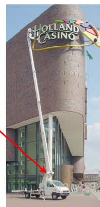
Slika 9.3: Nosilec tekstilnega stroja in dvigala, napolnjen z aluminijasto peno. [63]
