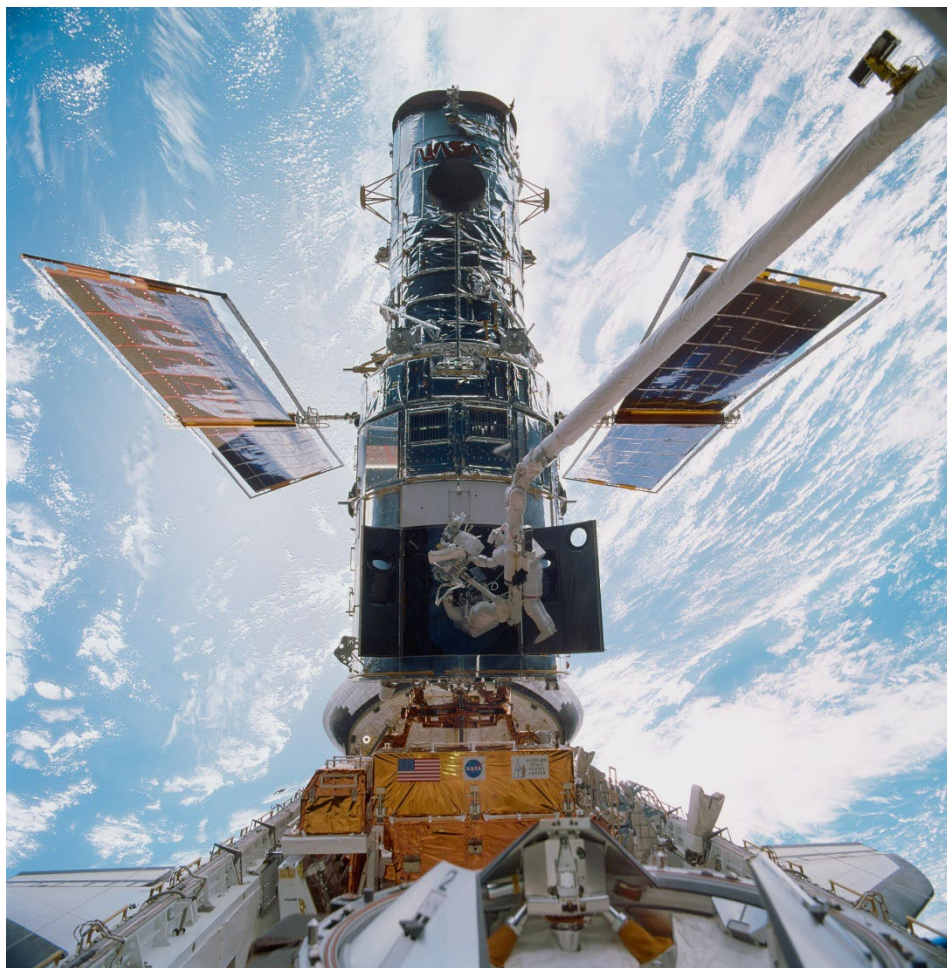
Slika 7: Astronavta Steven L. Smith in John M. Grunsfeld med vesoljskim sprehodom zamenjujeta žiroskope na vesoljskem teleskopu Hubble – rezultat inženirskega dela.
