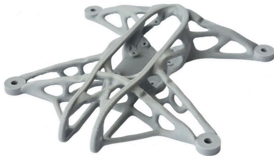
Slika 36: 3D natisnjen prototip okvirja drona.
