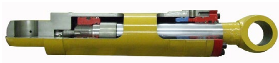
Slika 38: Hidravlični cilinder kot primer komponente tehničnega sistema za prikaz postopka analize FMEA.
