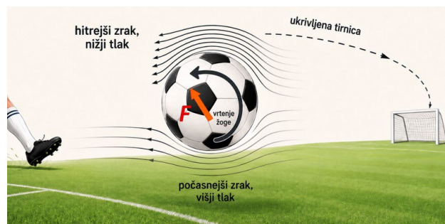
Slika 6.20: Magnusov pojav pri vrteči se nogometni žogi. Razlika v hitrosti zraka in tlaku na obeh straneh žoge vodi do nastanka sile F , ki povzroči ukrivljen let.
