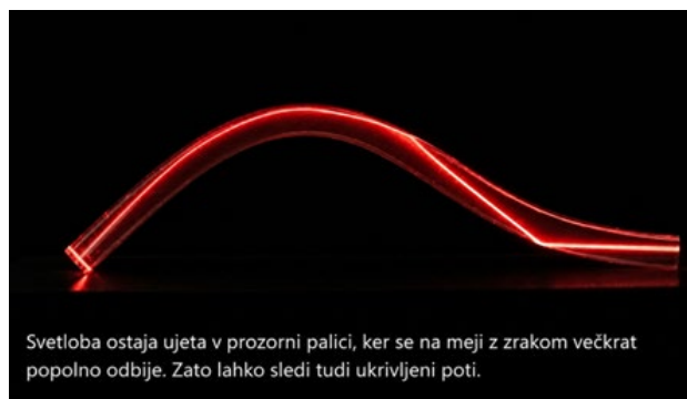
Slika 9.7: Vodenje svetlobe s popolnim odbojem. Svetloba ostaja ujeta v prozornem vodniku in lahko sledi tudi ukrivljeni poti.
