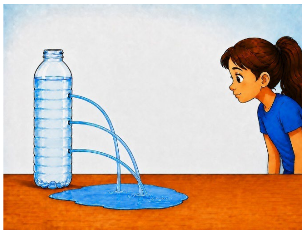
Slika 6.3: Iztekanje vode iz enako velikih lukenj v plastenki, ki so na različni globini.
