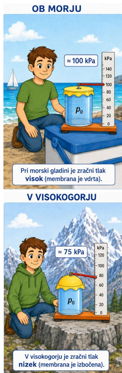
Slika 6.6: Primerjava merjenja zračnega tlaka ob morsk gladini in v visokogorju. V merilniku je zaprt zrak z normalnim tlakom p_0 , ki služi kot primerjalna oziroma referenčna vrednost. Ob morsk gladini je zunanji zračni tlak približno enak p_0 , zato je membrana skoraj ravna in kazalec kaže približno 100 \text{ kPa} . V visokogorju je zunanji zračni tlak manjši, zato tlak zaprtega zraka v merilniku membrano izboči navzven, kazalec pa pokaže manjšo vrednost, približno 75 \text{ kPa} .
