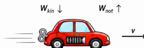
Slika 3.3: Energijske pretvorbe v avtomobilčku na vzmet. Ko avtomobilček vlečemo s silo F , opravljamo delo in mu dovajamo energijo, ki se v vzmeti shrani kot prožnostna energija. Po sprostitvi se prožnostna energija pretvarja v kinetično, zato avtomobilček pridobi hitrost v . Zaradi uporov se kinetična energija postopoma pretvarja v notranjo energijo avtomobilčka in okolice.
