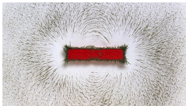
Slika 8.10: Železni opilki se v magnetnem polju ravnega magnetna namagnetijo in uredijo v značilen vzorec. Najgostejše so razporejeni ob polih magnetna, kjer je magnetno polje najmočnejše.
