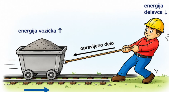
Slika 3.1: Delavec z opravljanjem dela prenese energijo na voziček. Kinetična energija vozička se zato poveča (↑), delavcu pa se energija zmanjša (↓).
