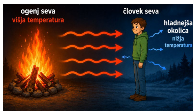
Slika 4.8: Ogenj in človek hkrati oddajata in sprejemata sevanje. Ker je ogenj toplejši, človek od njega prejme več energije, kot je v njegovo smer odda, zato je neto prenos energije usmerjen od ognja proti človeku.
