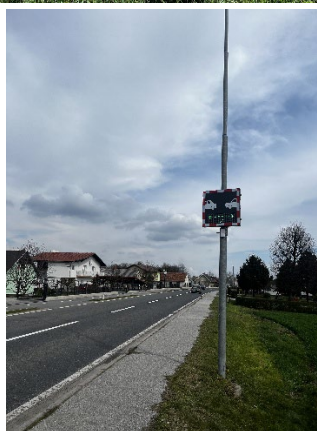
Slika 2: Prikazovalnik LED, namenjen prikazovanju ustreznosti varnostne razdalje: neustrezna (vrstica 1) in ustrezna varnostna razdalja med vozili (vrstica 2).
