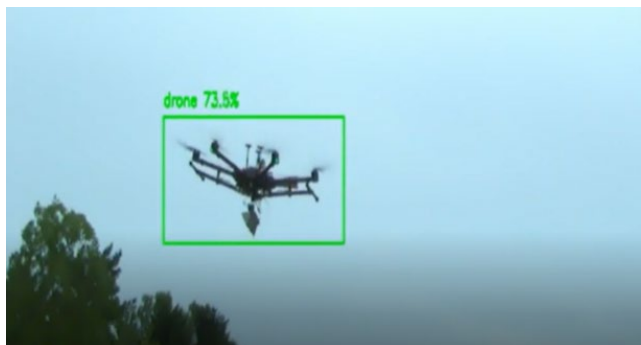
Slika 10: Sočasna detekcija z optičnim in radarskim sistemom Vir: lasten
