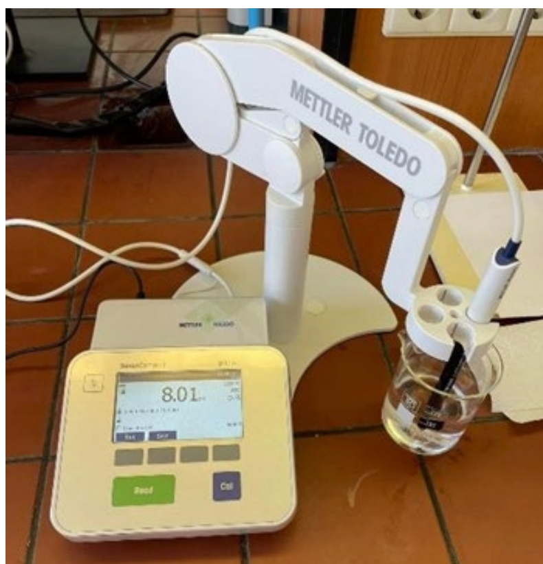
Slika 3: pH meter za merjenje pH vrednosti. Vir: lasten.
