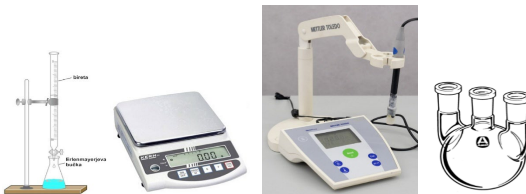
Slika 9: Bireta in Erlenmayerjeva bučka, tehtnica, pH meter, trovrata bučka.
