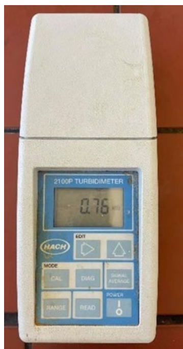
Slika 4: Turbidimeter in kiveta z vzorcem za merjenje motnosti. Vir: lasten.
