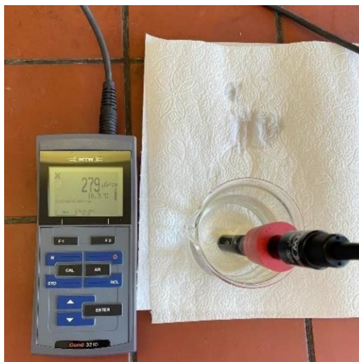
Slika 2: Merilnik električne prevodnosti (konduktometer). Vir: lasten.
