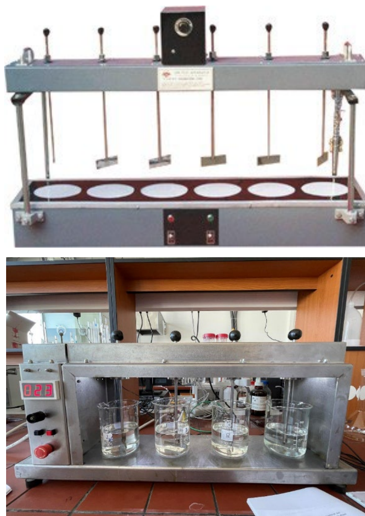
Slika 10: Laboratorijski flokulator. Vir: lasten.
