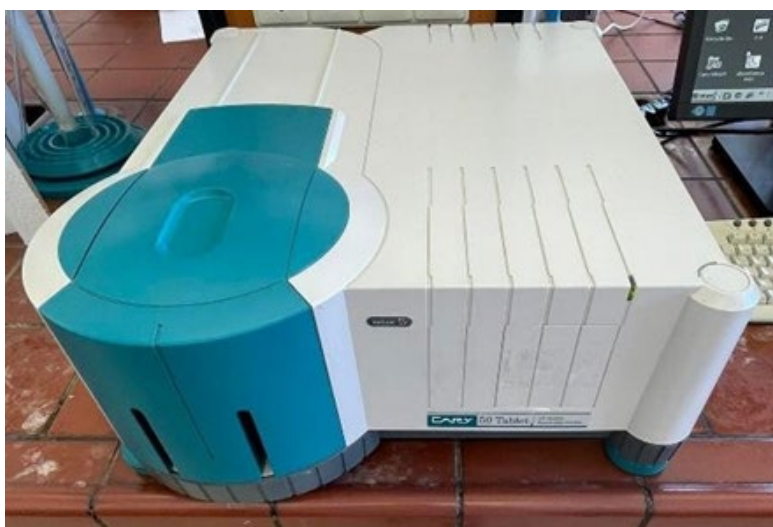
Slika 5: UV-ViS spektrofotometer za določanje obarvanosti. Vir: lasten.
