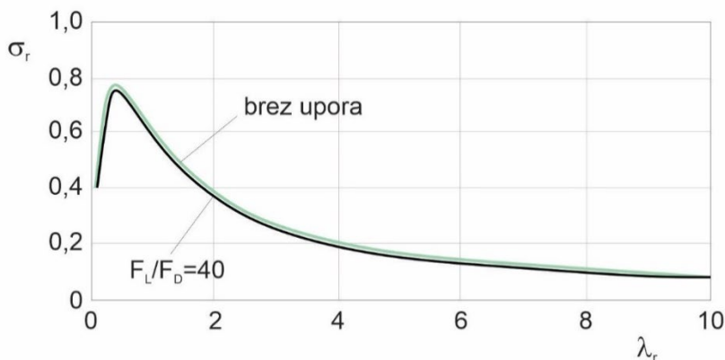
Slika 3.23: Sprememba parametra oblike lopatice vzdolž lopatice z upoštevanjem upora in brez njega.
