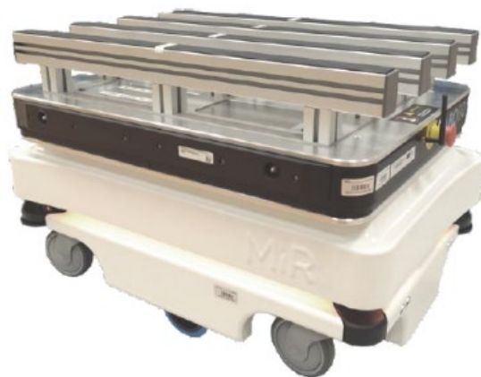
Slika 6.7: Primer zgornjega zaklepnega modula.
