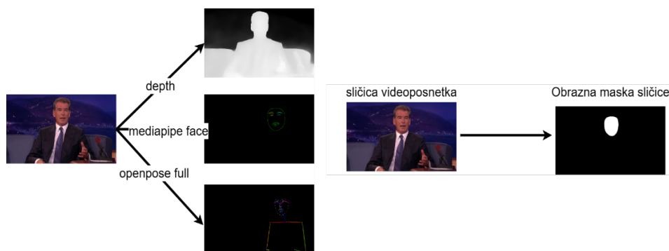
Slika 4: Levo: prikaz izdelanih map kontrolnih mrež različnih predprocesorjev. Desno: prikaz obrazne maske.
