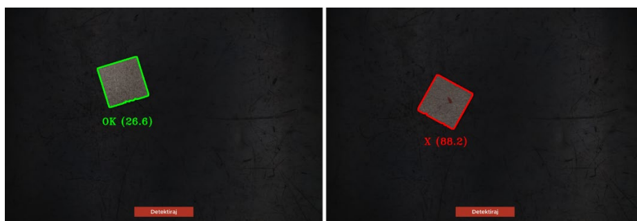
Slika 4: Detekcija anomalij na ploščicah. Levo: dober primer, desno: anomalija (verjetnost anomalije v oklepajih).
