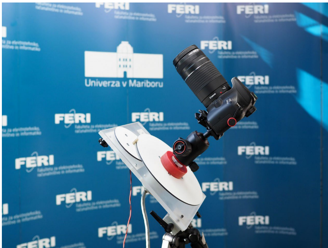
Slika 1: Fotoaparati pritrjeni na sledilnik
