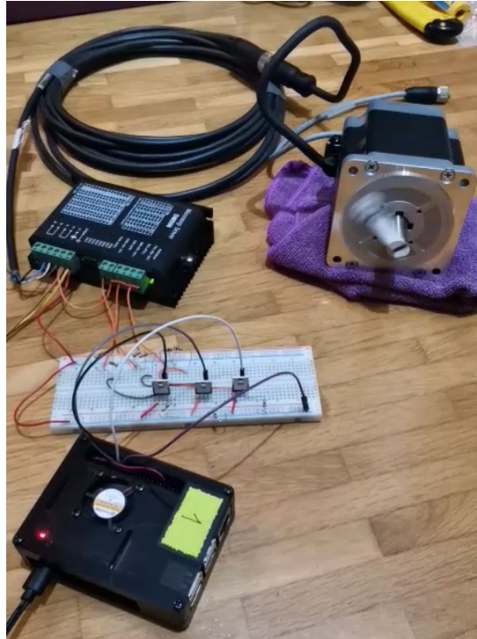
Slika 1: Pogon koračnega motorja z Raspberry Pi
