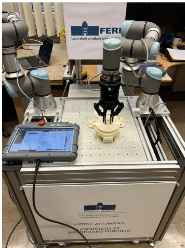
Slika 1: Sestava planetnega gonila s pomočjo kolaborativnega robota
