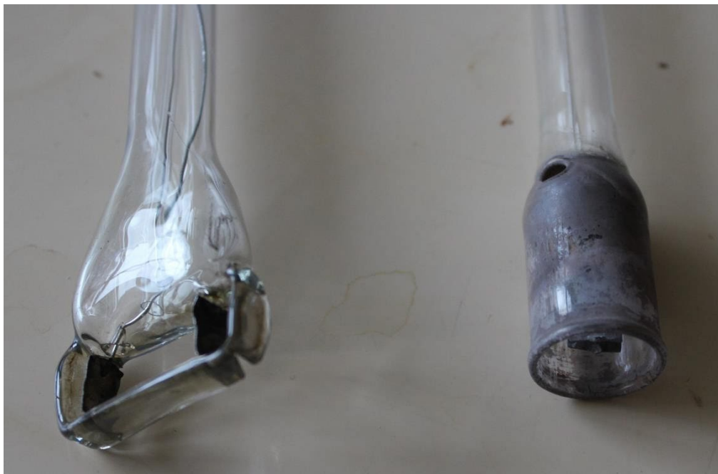
Slika 7: Konduktometrični celici s Pt elektrodama za merjenje prevodnosti raztopin (levo – celica z l = 20 mm, desno – celica z l = 2 mm).
