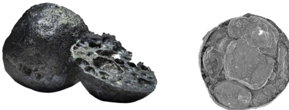
Slika 3.9. Volumetrični model por v kroglici aluminijeve zlitine
