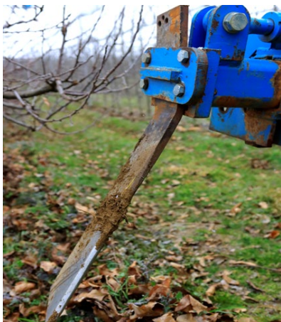
Slika 2: Naprava za rez korenin pod kotom 45°
