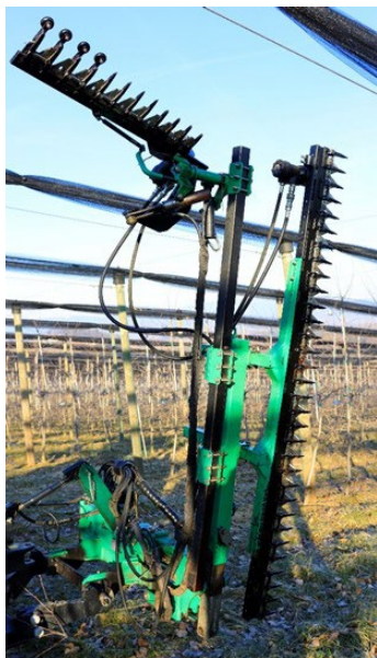
Slika 2: Naprava za rez s kosilnim grebenom (levo) in značilne posledice rezi grebenske kosilnice na poganjku
