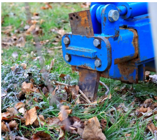
Slika 3: Rezilo naprave za rez korenin, poglobljeno na delovno globino
