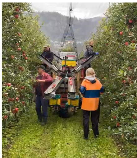
Slika 4: Prikaz obiranja s pomočjo obiralnega stroja Pluck-o-trak foto: N. Rumpret, 2021.
