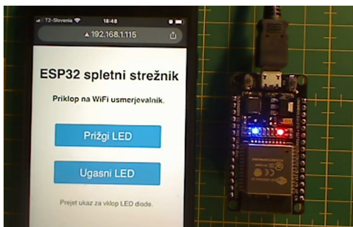
Slika 26: Uporabniški vmesnik, prikazan na mobilnem telefonu (levo), ter modul esp32 (desno)
