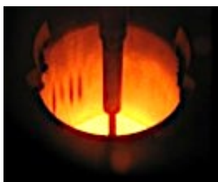
Taljenje v vakuumski indukciji peči
