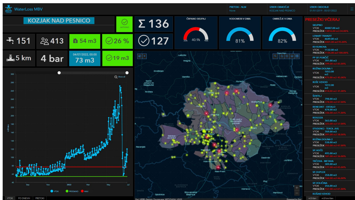
Slika 7: Aplikacija za nadzor zaključenih merilnih območij »WaterLoss MBV«.
