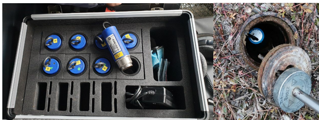
Slika 5: Loggerji šuma se z magnetom pripnejo na vodovodno cev/priključek/ventil.
