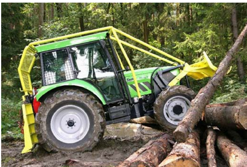
Slika 3: Nepravilno rampanje lesa
