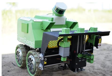
Slika 1: Robot Farmbeast s sprednjim priključkom
