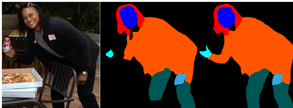
Slika 1: Na tem primeru vidimo, da dodatni nalogi skeleta in globinske predstavitve doprineseta koristne kontekstualne in strukturne informacije o človeškem telesu. Druga slika prikazuje segmentacijsko masko, ki jo izdelal naš večciljni model, ki vsebuje naloge za segmentacijo in napoved skeleta. Tretja slika prikazuje segmentacijsko masko, ki jo je ustvaril naš večciljni model z dodatno nalogo napovedi globinske predstavitve poze. Vidimo lahko, da dodatna naloga bistveno izboljša uspešnost segmentacije.
