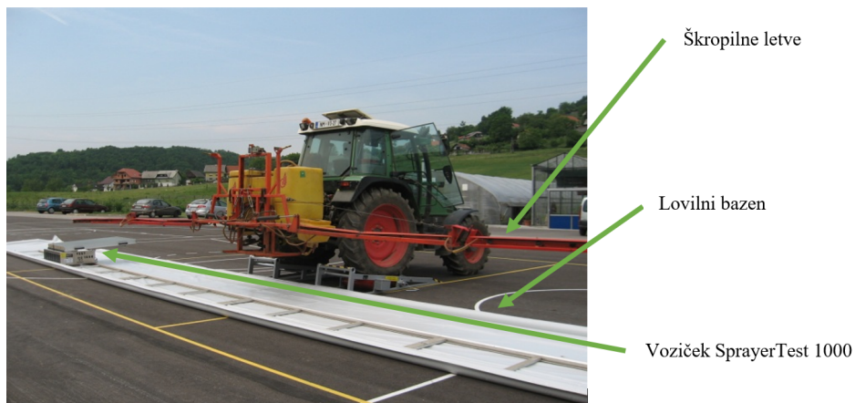
Slika 3: Postavitev traktorja s škropilnico na klančino za merjenje prečnega nanosa (voziček na končni točki)
