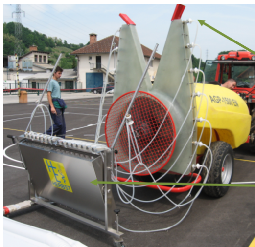
Slika 5: Naprava za meritev pretoka šob na pršilnikih (Vir: Lastni)
