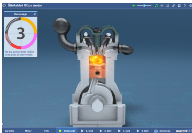
Slika 12: Zaslonski posnetek animacije delovanja 4-taktnega Ottovega motorja (Vir: Mozaik Education, 2018)
