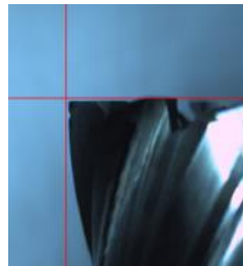
Slika 3: Detekcija robov orodja; (foto: avtorja)
