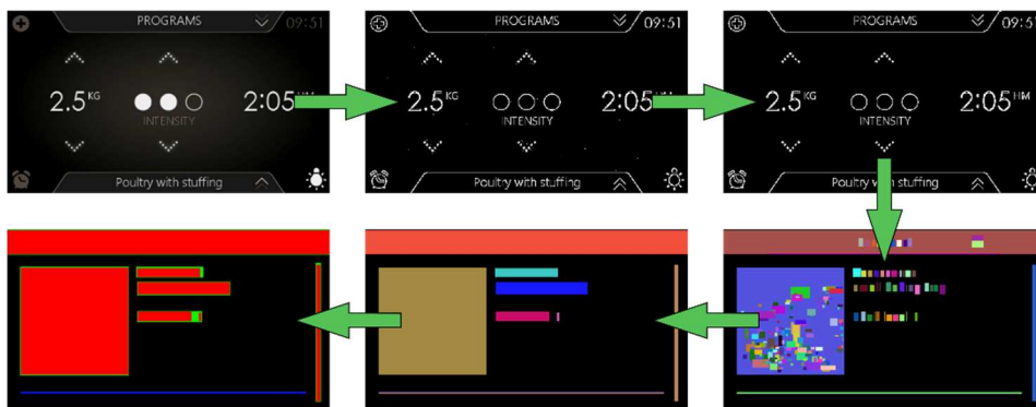
Slika 2: Vmesni rezultati posameznih korakov segmentacije. Začetni koraki na sliki prikazujejo segmentacijo zaslona z nastavitvami pečenja (prva vrstica), končni pa segmentacijo zaslona z receptom (druga vrstica).
