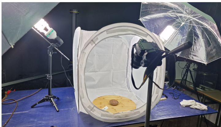
Svetlobni šotor z vrtljivo mizo za 3D fotogrametrično digitalizacijo Light tent with turntable for 3D photogrammetric digitisation
