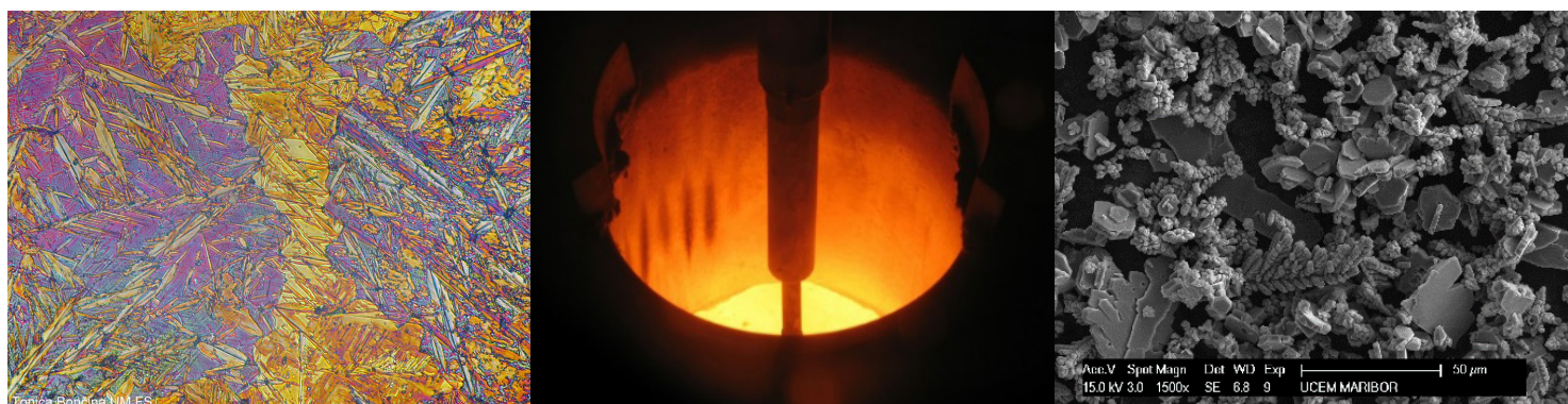
Martenzitna struktura jekla, barvno jedkanje in svetlobna mikroskopija (levo), taljenje v vakuumski indukciji peči v Laboratoriju za materiale (sredina), ekstrahiran vzorec Al-zlitine (desno).
