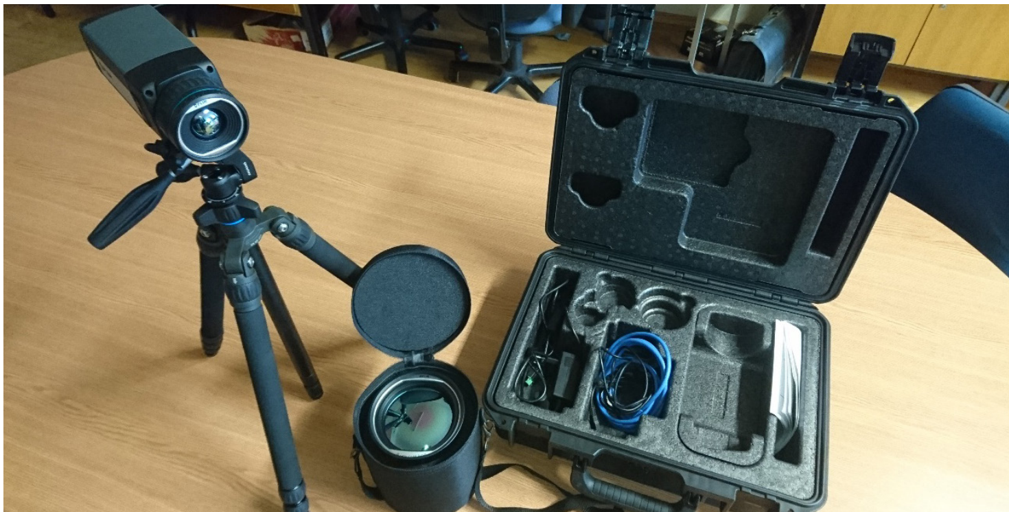
RFLIR A655SC termokamera FLIR A655SC thermocamera
