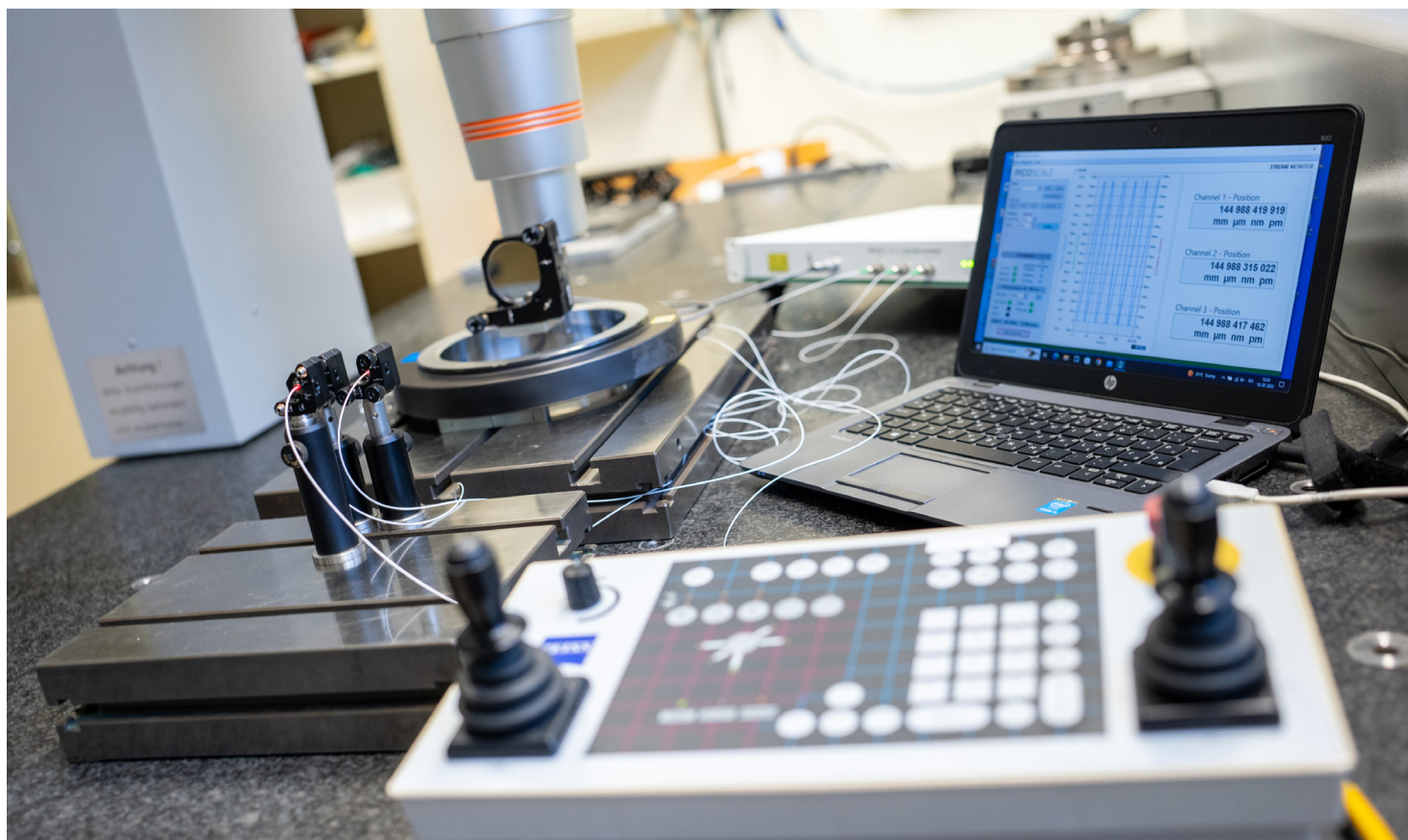
Umerjanje obroča z lasersko interferometrijo z nanometriško ločljivostjo Ring gauge calibration using laser interferometry with nanometre resolution
