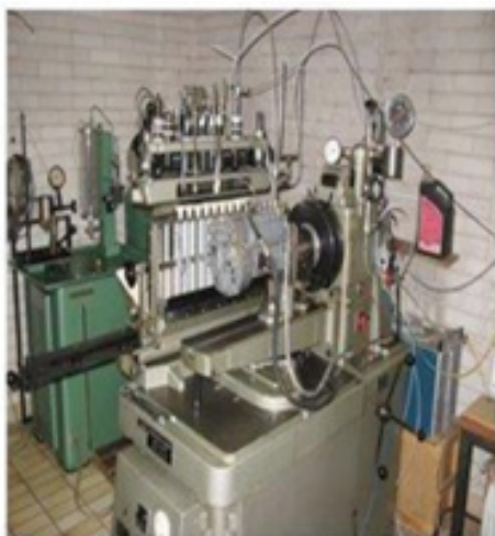
Preskuševališče za visokotlačne vbrizgalne sisteme Testing facility for high pressure injection systems
