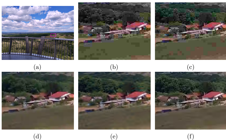
Slika 3.20: (a) Izbran del slike ločljivosti 4000 \times 3000 , ki je stisnjena na 0,13 bpp z (b) JPEG in Huffmanovim kodirnikom, (c) JPEG in aritmetičnim kodirnikom, (d) WebP, (e) JPEG XL in (f) AVIF (vir slike: lastni).
